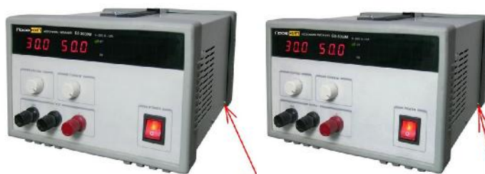
Рисунок 2 – Схема пломбировки от несанкционированного доступа.
